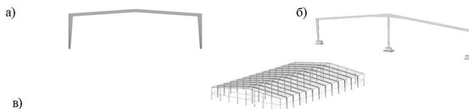
Рисунок 1 – Расчетные схемы однопролетной пластинчатой (а), двухпролетной пластинчатой (б) и двухпролетной стержневой пространственной рам
