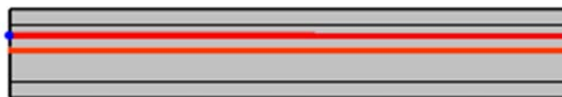
Рисунок 1 – Плоская модель стержня из цементного теста. Красным цветом указаны горизонтальные линии на высоте 5 и 7 см, вдоль которых вычислено распределение напряжений Мизеса
