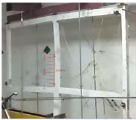
Рисунок 1 – Данные фотофиксации испытания железобетонной рамы первой серии при внезапном отказе угловой колонны
