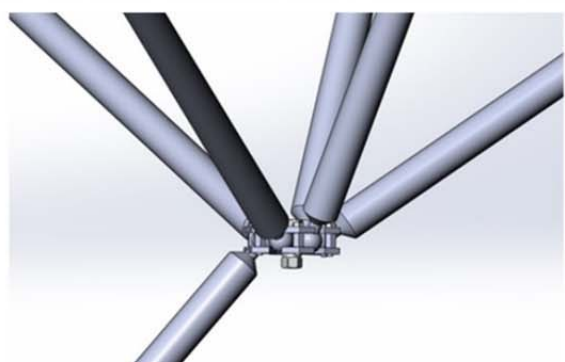
Рисунок 2. Шарнирный узел пространственной стержневой конструкции
